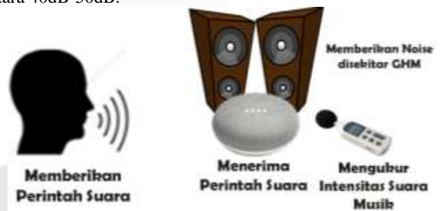
Gambar 4. 7 Skema Pengujian Terhadap Noise
