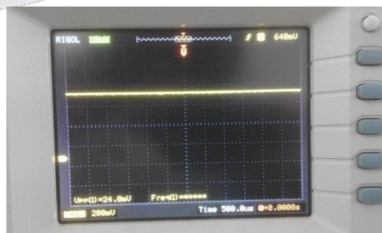
Gambar 4.10 Gelombang *Output 2* Op-Amp saat Tidak Mendeteksi Sinyal GSM
