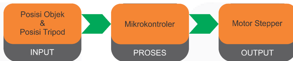
Gambar 8 blok diagram komunikasi objek dengan tripod
