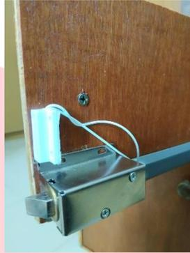
**Gambar 3.5** Solenoid dan Magnetic door switch
