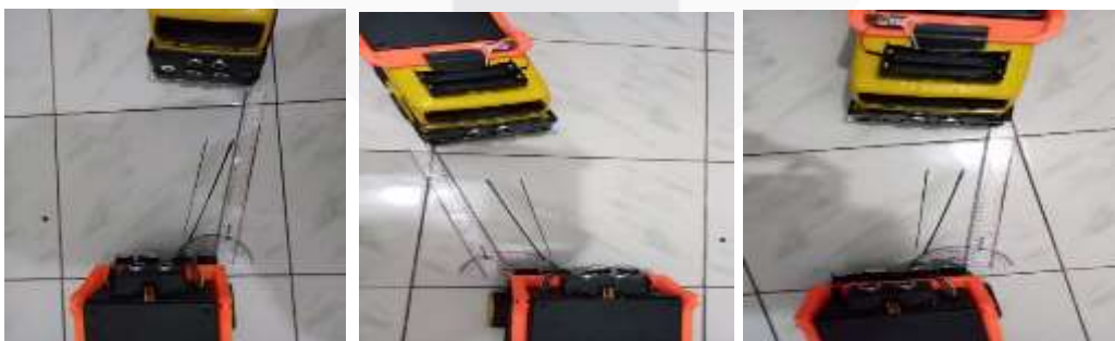
Gambar 3.13 Skema Pengukuran Sudut Pada Sensor Ultrasonik 5^\circ, 10^\circ, 15^\circ
