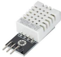
Gambar 2.3 Sensor DHT22
