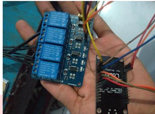
Gambar 4. 3 Skema pengkabelan relay pada Nodemcu ESP8266
