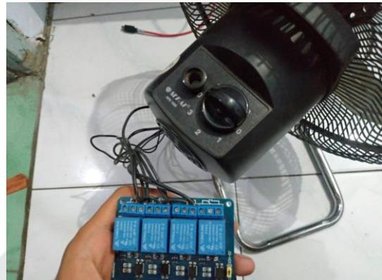
Gambar 4. 4 Skema pengkabelan dari relay untuk kipas angin
