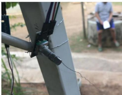
Gambar 3.6 Pemasangan sensor pergeseran tanah
