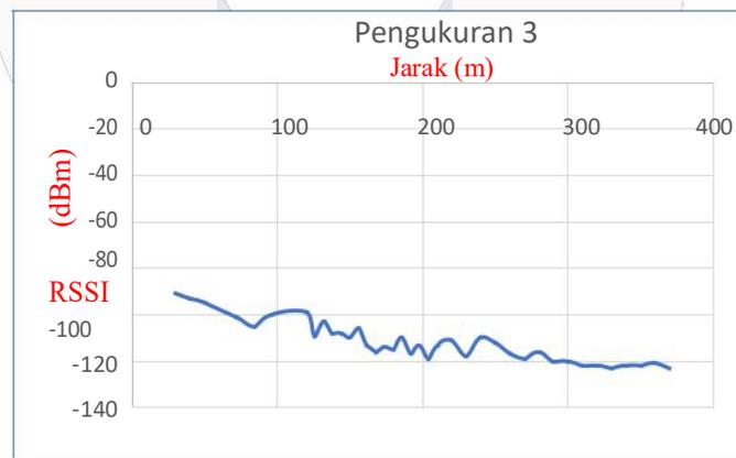
Gambar 4.6 Grafik pengujian jarak komunikasi LoRa
