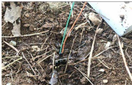
Gambar 3.5 Pemasangan sensor kelembapan tanah
