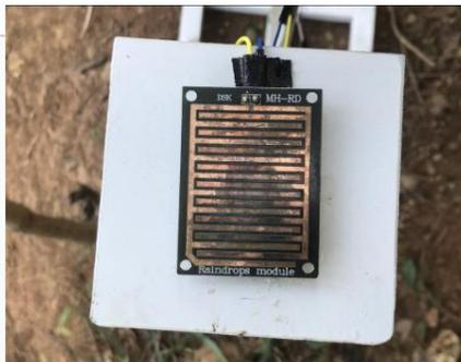
Gambar 3.4 Hasil pemasangan sensor hujan
