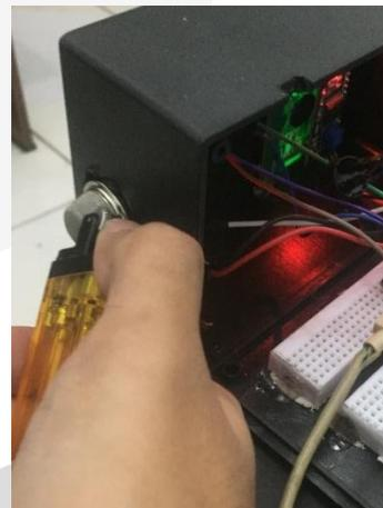
Gambar 4.10 Pengujian Sensor MQ-6
