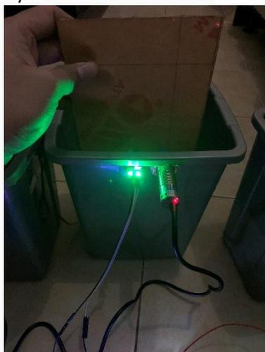
Gambar 4. 3 Pengujian Deteksi Jenis Sampah Anorganik Nonmetal
