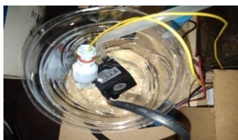
Gambar 4.8 Pemasangan Water Level
