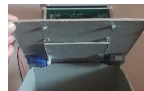
Gambar 4.8 Proses pengujian motor servo menutup katup dispenser pakan
