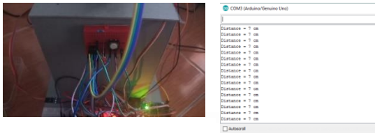
Gambar 4.11 Kondisi jarak <=7 lampu indikator mati
