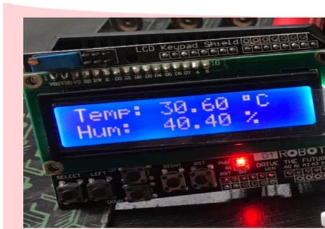
Gambar 4. 6 Hasil Pengujian Sensor Suhu dan Kelembaban DHT22
