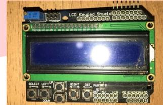
Gambar 2. 6 LCD 16x2
