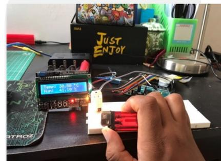
Gambar 4. 3 Sensor DHT22 Membaca Suhu Panas
