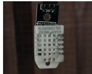
Gambar 2. 3 Sensor Suhu dan Kelembaban DHT22
