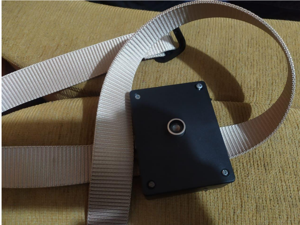
Gambar 4.3 Implementasi Bagian Penerima Ultrasonik di Sabuk
