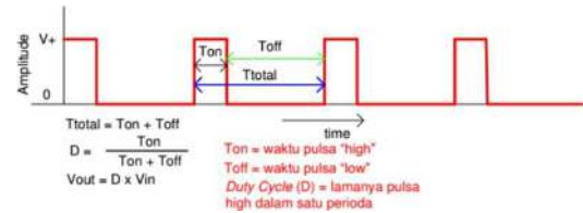
Gambar 2.6 Sinyal Amplitudo PWM
