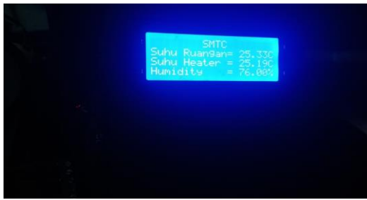
Gambar 4.3 Hasil Pengujian Sensor Kelembapan
