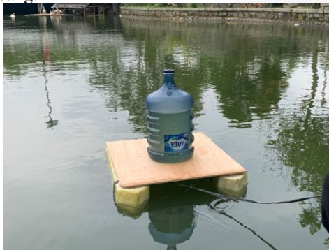
Gambar 4. 3 Pengujian Beban Maksimal Lambung Kapal
