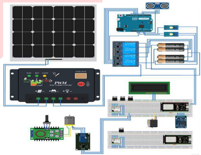
GAMBAR 11 (SKEMA RANGKAIAN SISTEM KESELURUHAN)
