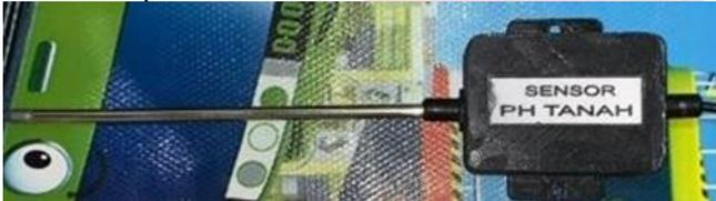
**Gambar 7 Sensor pH tanah**
