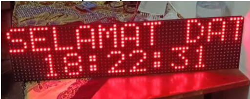
GAMBAR 6 Tampilan pada LED Saat Standby
