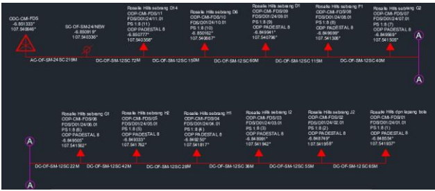
GAMBAR 7 Titik Lokasi Odp Pedestal
