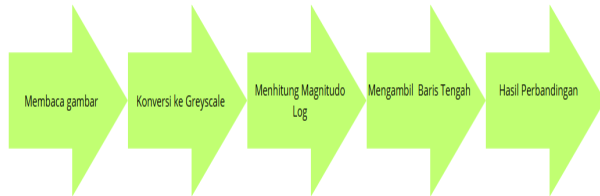
GAMBAR 3 Blok Diagram Pengujian HFR
