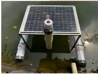
GAMBAR 4 Implementasi Sensor di Danau Situ Tekno
