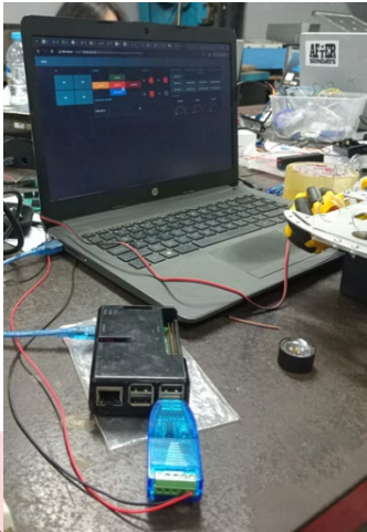
GAMBAR 6 Implementasi Dashboard kendali dengan RS485
