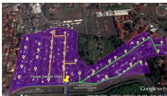
Gambar 4 Perancangan Kabel Distribusi Skenario 1
