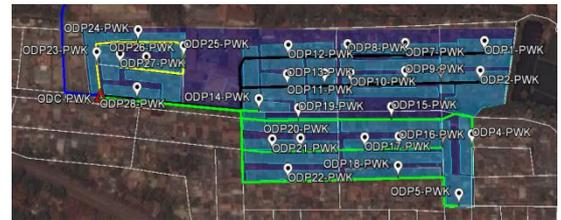
Gambar 3.8 Perancangan Kabel Distribusi
