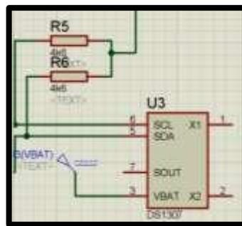
Gambar 4. Rangkaian RTC
