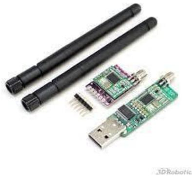
**Gambar 2.5** Modul Telemetri 3DR
