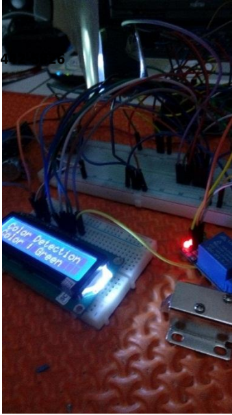
Gambar 4.5 – Skenario penginputan warna hijau
