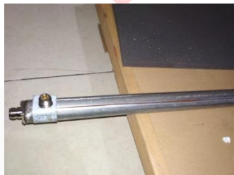
Gambar 3.4 Konduktor luar slotted line dari besi hollow
