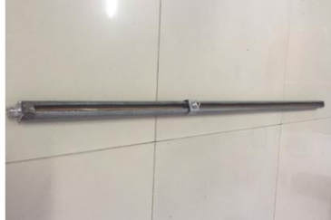
Gambar 3.6 Slotted line yang telah direalisasi
