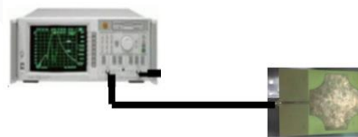
Gambar 4.13 Pengukuran SWR menggunakan Network Analyzer pada antenna
