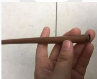
Gambar 3.5 Konduktor dalam slotted line dari pipa tembaga
