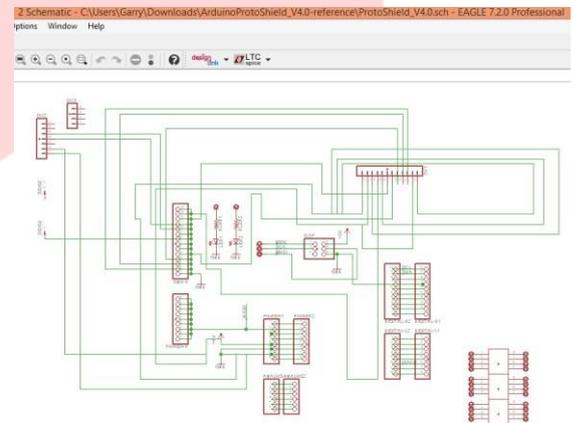
Gambar 5 Perancangan Rangkaian Schematic Arduino Sensor KIT
