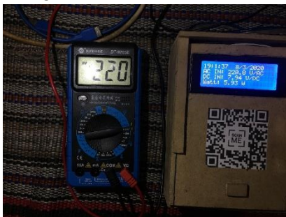
Gambar Error! No text of specified style in document..15 Kalibrasi sensor tegangan ZMPT101B dengan Multimeter
