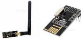
Gambar 3 Modul Komunikasi nRF24L01
