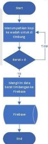
Gambar 22 Flowchart Sistem Pada *Load Cell*
