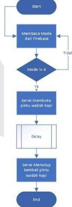
Gambar 20 Flowchart Sistem Servo *Storage Kopi*
