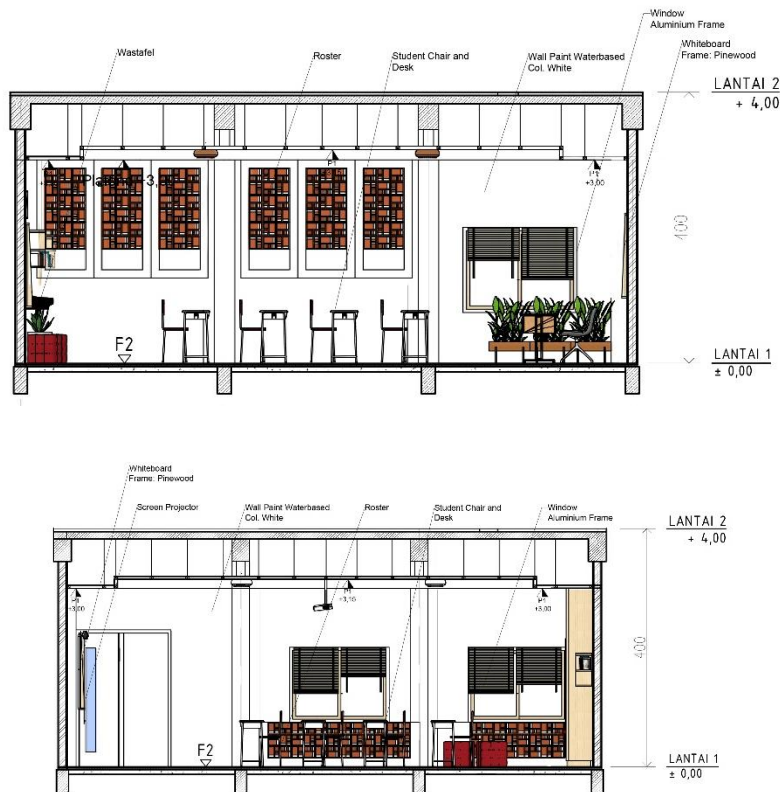
Gambar 4. Wooden Blind dan roster sebagai pengatur intensitas cahaya alami pada ruang kelas Sumber: Dokumentasi Penulis, 2019
