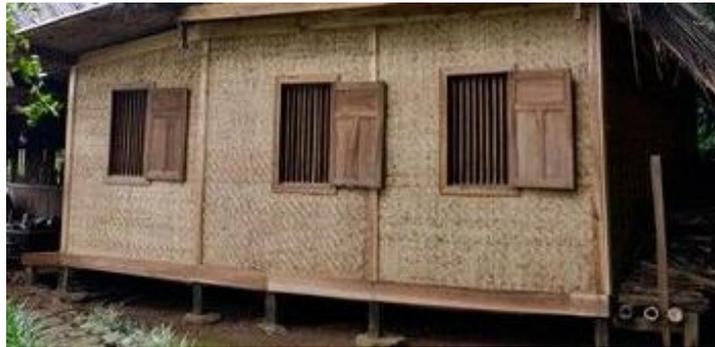
*Gambar 3. 1 Sistem penghawaan natural rumah adat Sunda menggunakan susunan kayu
