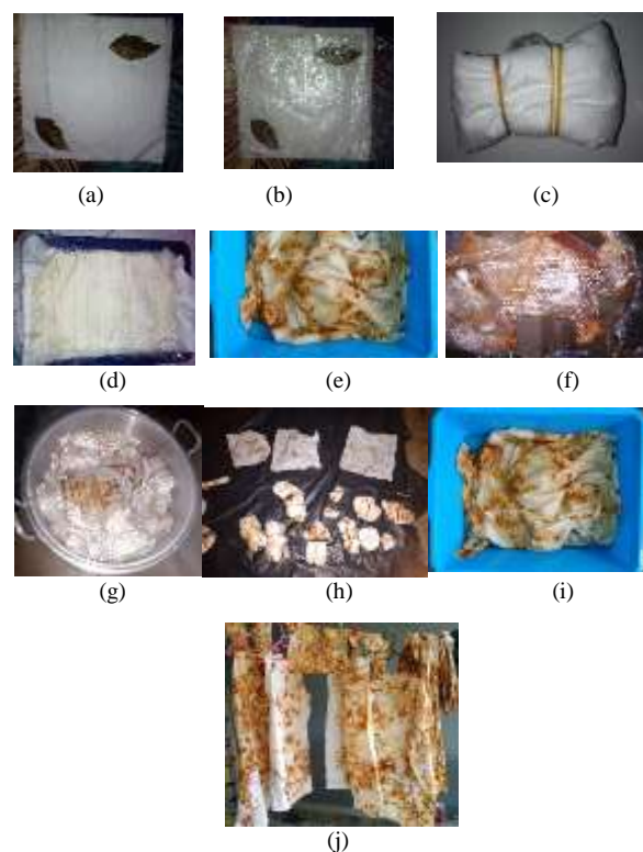
Gambar III. 14 Proses : (a)100ml garam, (b)larutkan air garam,(c)kain diamkan selama 15 mnt, (d) kain lembab di beri material besi, (e)Letakakan bubble wrap di atasnya (f) letakakan kain lagi (diualng) sesuai kebutuhan (g) proses penjemuran selama 10 hari ,(h) mordant akhir (j) penjemuran
