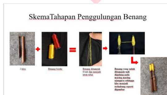
Gambar 2 Skema tahap penggulungan benang bordir pada klos Sumber: Dokumentasi Pribadi 2021
