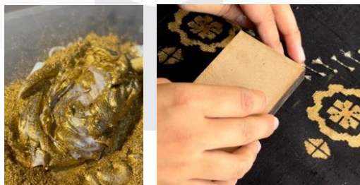
Gambar 10. Pencampuran adonan dan stamping Sumber : Dokumentasi pribadi
