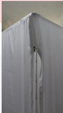
Gambar 5 Proses Menyatukan Kain Dengan Kerangka Pipa (Sumber : Dokumentasi Pribadi Penulis (2022))
