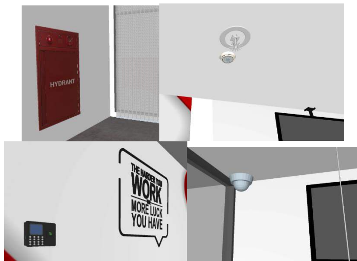
Gambar 4.9.4. 1 Hydrant, Smoke Detector dan Sprinkler, Fingerprint Scanner dan CCTV Sumber : Dokumen Pribadi, 2023.
