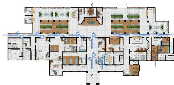
Gambar 11 Konsep penghawaan alami area rawat jalan Sumber: Dokumentasi Pribadi, 2023
