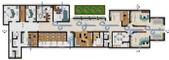
Gambar 12 Konsep penghawaan alami area lasik center Sumber: Dokumentasi Pribadi, 2023
