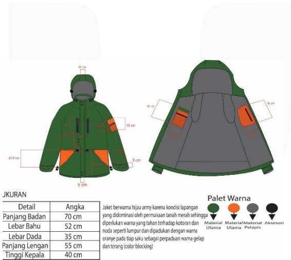
Gambar 17. Gambar Kerja Utility Jacket Sumber : (Dokumentasi Penulis)
