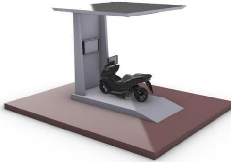
Gambar 12. Tata Letak Stasiun Pengisian Sepeda Motor Listrik 2
