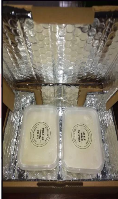
Gambar 6 Uji Coba Insulasi Kemasan sumber: dokumen penulis
