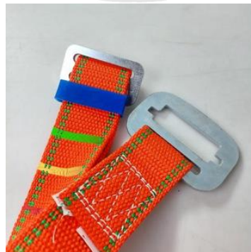
Gambar 2 Penambahan Penanda Pada Strap Atau Tali
