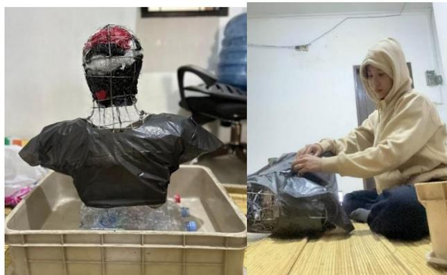
Gambar 12. Proses membungkus kerangka dengan plastik
