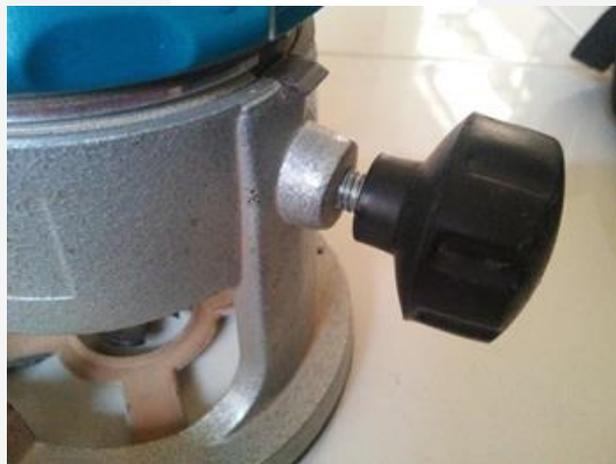
Gambar 3.1: Baut pengunci mesin profil dan penahan putaran bodi mesin
