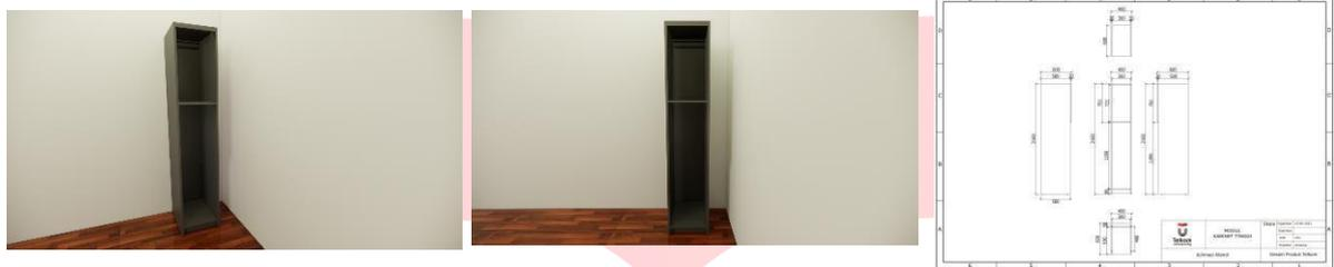
**Gambar 7. Visualisasi & Gambar Teknik Kabinet Tinggi**
