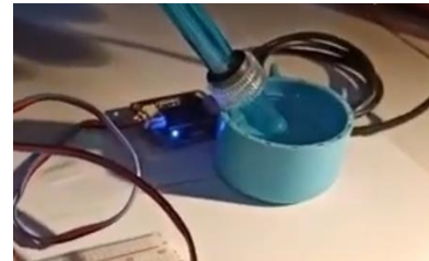
Gambar 3. Modul Sensor pH dengan probe
