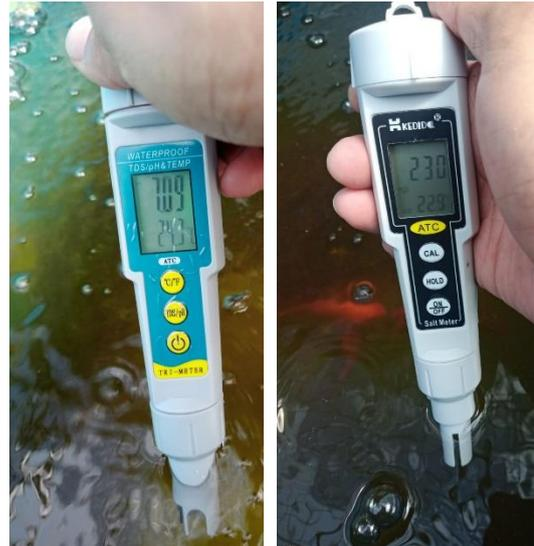
**Gambar 5.** Proses pengukuran keasamaan dan kepadatan partikel dalam air
