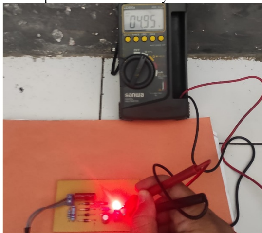
Gambar 6. Pengukuran keluaran PCB konverter AC to DC
